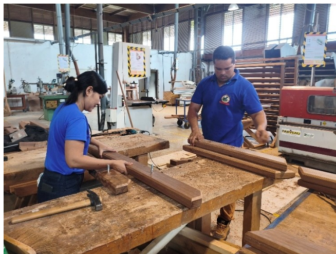
Foto 32 - Montagem da base das mesas do kiosque.
